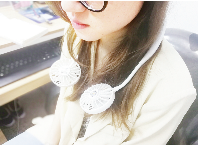
有些挂脖风扇网罩缝隙过大,长发容易被卷入。
