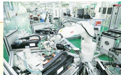
机器人正精准有序地检测产品主板
