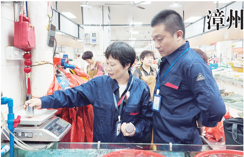
市计量所检定员使用标准砝码检查市场内电子计价秤 本报记者 黄天航 摄
