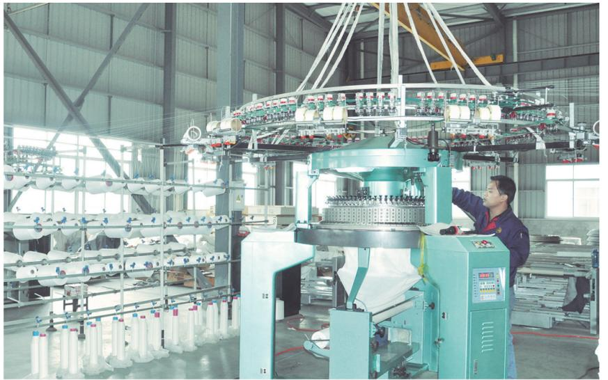
在华安经济开发区针织机械产业园,企业工人正在对大圆机整机进行调试。
