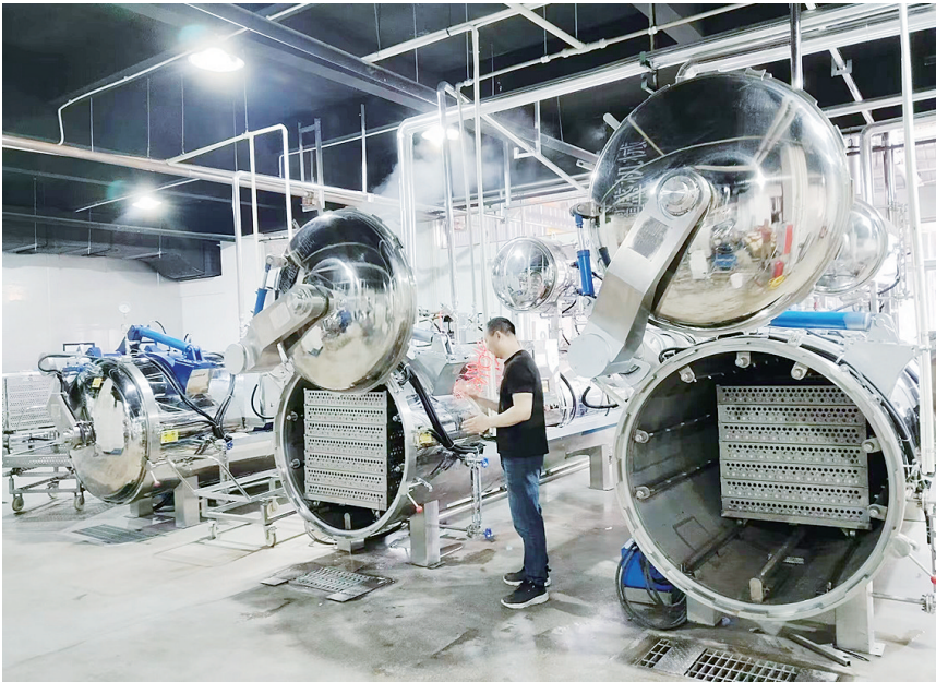
觅康食品崭新的灭菌釜设备投入使用,每日可高温快速杀菌处理瓶装鲍鱼、燕窝等高端食材30万瓶。
