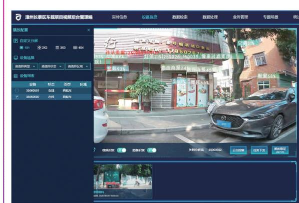
一大早,长泰区数字城市指挥中心的采集员赖胜波便换上制服、跨上装配智能摄像头的电动自行车,开启一天的城市巡查采集工作。这辆车看似普通的电动自行车是长泰区城市管理和综合执法局提升管理效能的关键装备。当它在大街小巷穿梭巡查时,车尾的AI“电子眼”便会持续对周围环境进行扫描,精准识别井盖破损、垃圾乱堆等数十类城市管理问题。一旦发现异常情况,系统将瞬间锁定问题类型及位置,仅需几秒便能完成精准拍照并红框标注,随后将包含地址、案件信息上传至后台。
